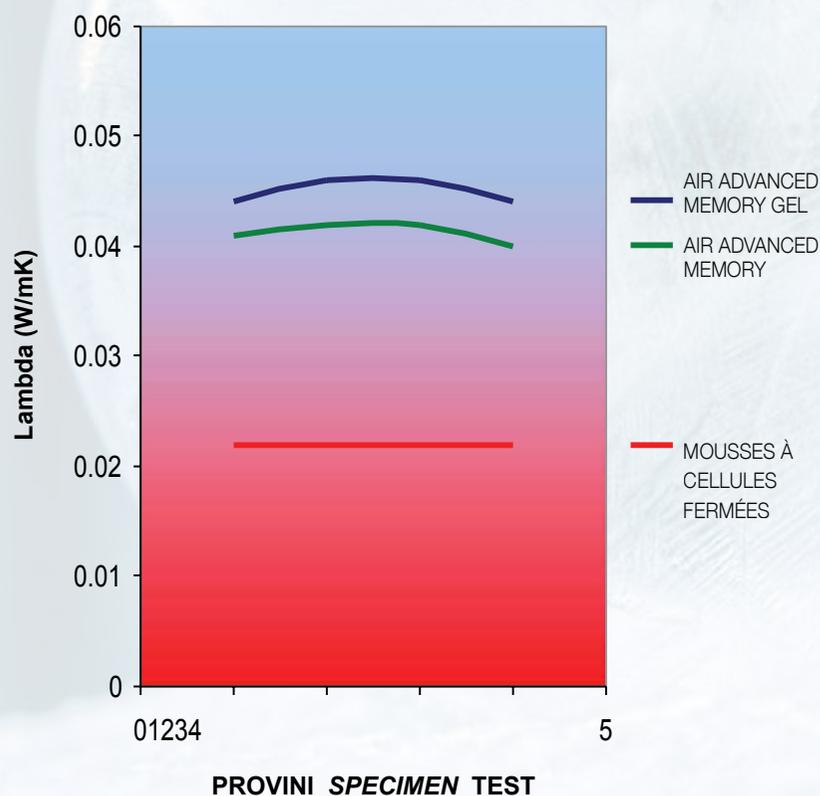
Les courbes du graphique montrent comment la dissipation de la chaleur se produit beaucoup plus efficacement dans les mousses à cellules ouvertes AIR que dans les mousses visco normales à cellules fermées. Le test a été effectué conformément à la norme UNI EN 12667.
